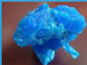
Exemple d'échantillon polycristallin qu'il ne faut pas obtenir
